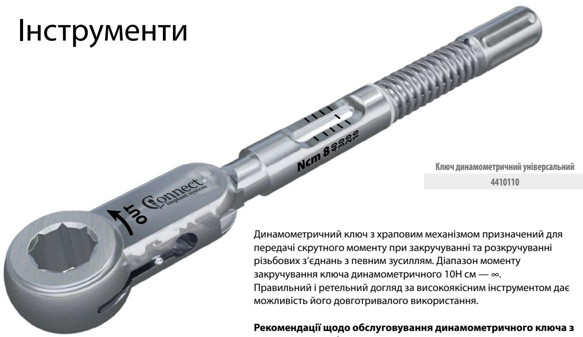
Динамометричний ключ з храповим механізмом призначений для передачі скрутного моменту при закручуванні та розкручуванні різьбових з'єднань з певним зусиллям. Діапазон моменту закручування ключа динамометричного 10Н см — ∞.
